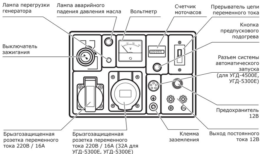
**Рис. 3. Схема панели управления генераторов УГД-5300Е(-1)**
