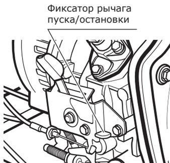
Рис. 18. Остановка генератора
