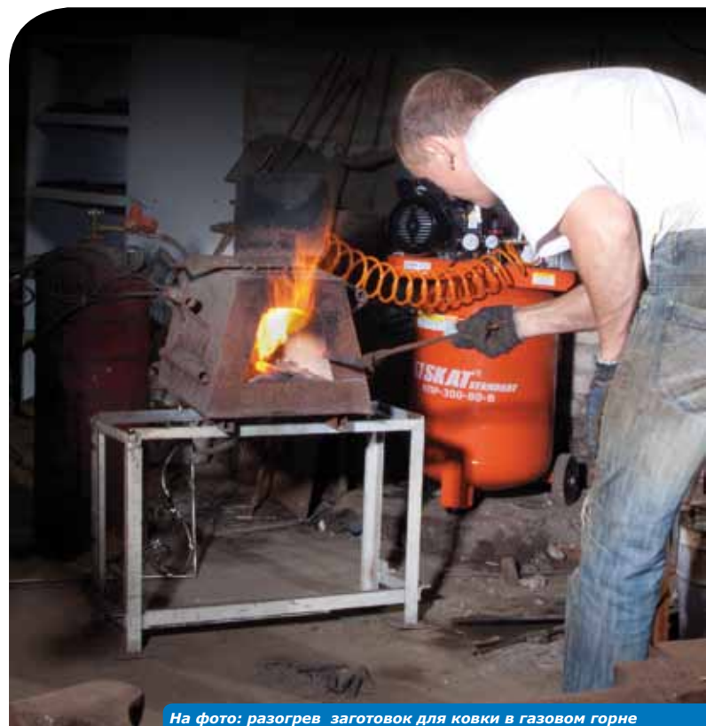
На фото: разогрев заготовок дляковки в газовом горне
